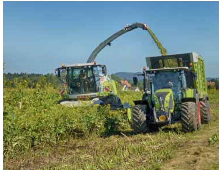
Silphieernte mit dem Maishäcksler mit GPS-Erntevorsatz.
