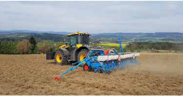
Aussaat der Silphie: Mit der neuartigen Sätechnik am Traktor können in einem Arbeitsgang die Silphiesamen und der Mais im Boden abgelegt werden.
