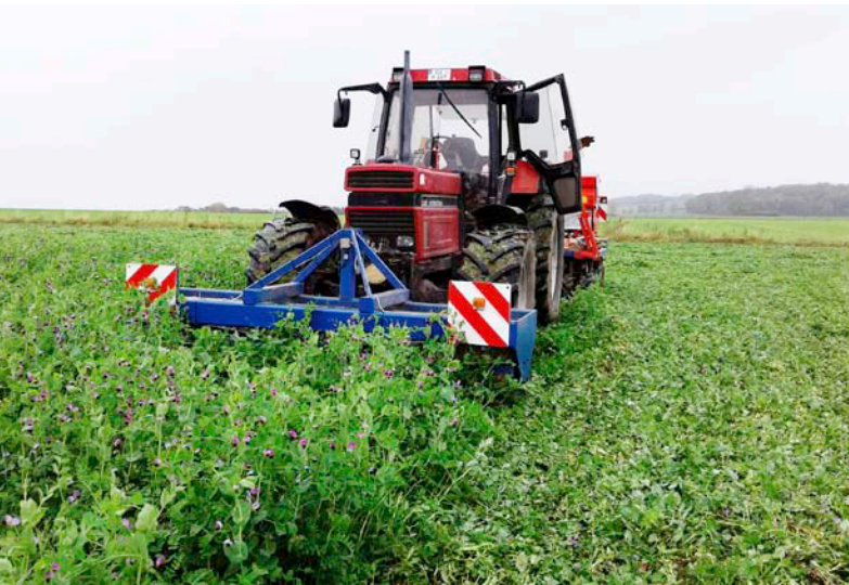
Direktsaat in grüne Zwischenfrucht. Die Messerwalze vorne am Schlepper drückt die Pflanzen an den Boden und zerstückelt sie.
